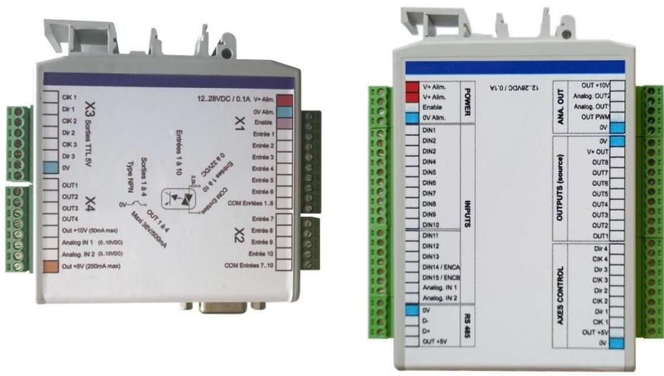
Les sorties de la carte 3 axes V2 sont de type NPN, c'est à dire qu'à l'état 1 elles tirent la tension d'alimentation (+24V) traversant la charge (bobine d'un relais, Led+résistance, etc...) vers le 0V.
